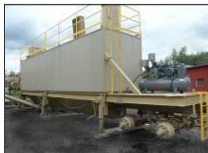
**6 – 7. Полуприцеп: Мобильная система хранения и обогрева битума (2 шт. х 50 м<sup>3</sup>)**
